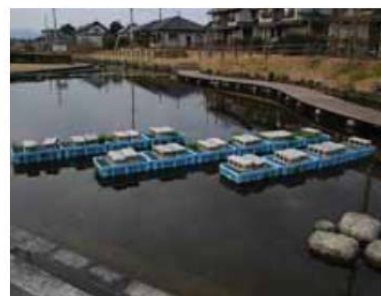
木炭浄化（接触酸化法の一つ）
